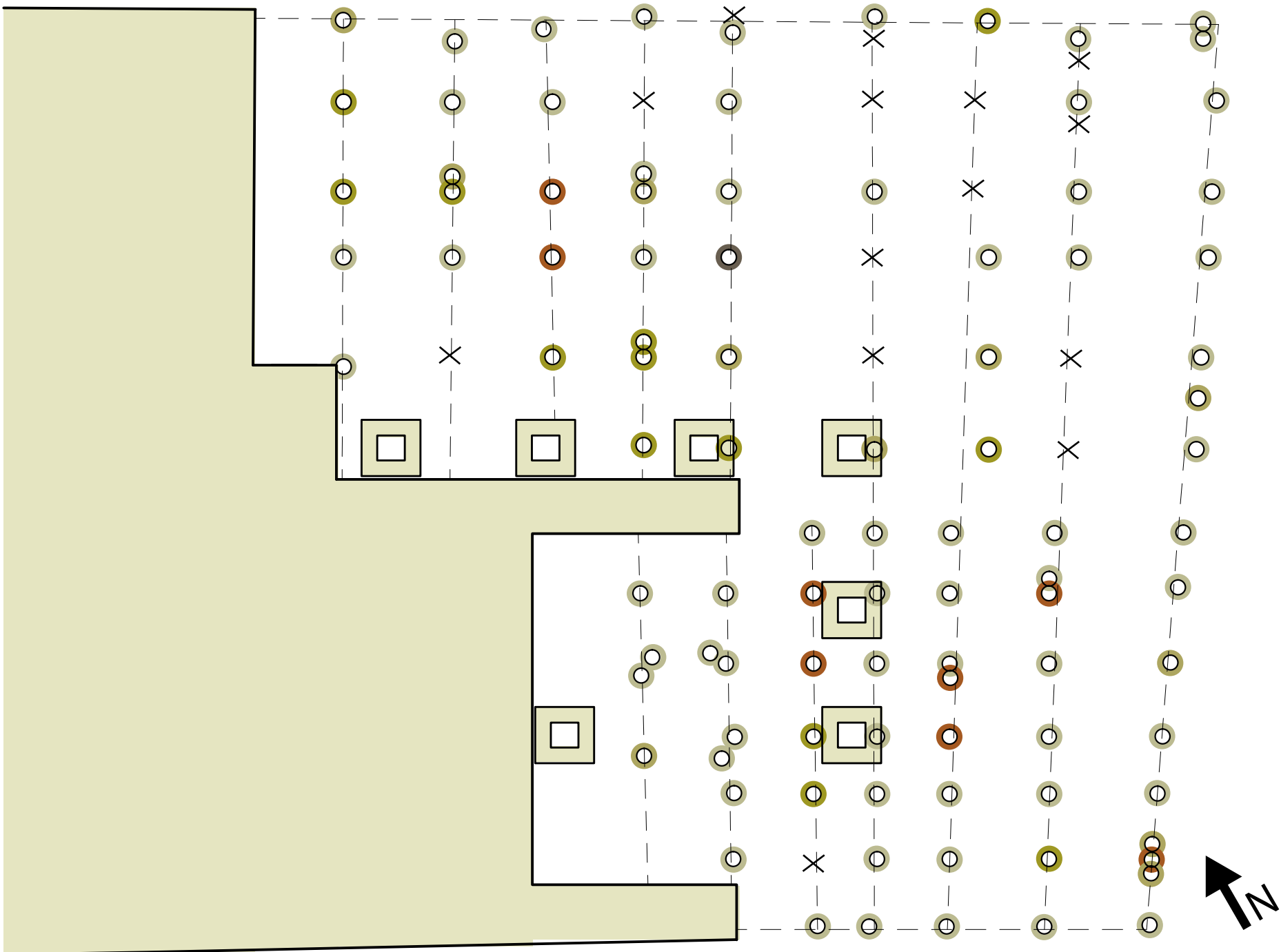
Figuren viser fundamentet av påler, betongsøyler og gråstein, og tilstanden til pålene.
