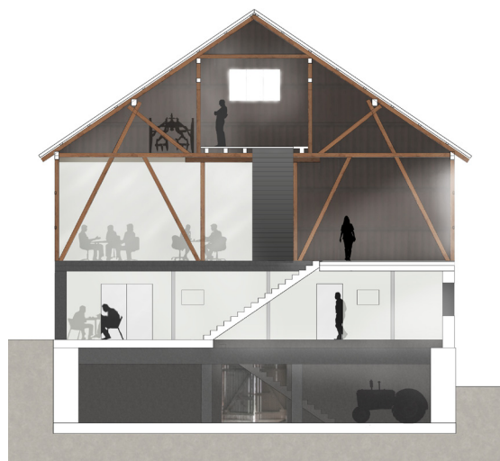
Snitt A-A gjennom østfløyen 1:250 Inngangssonen
