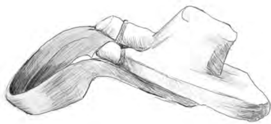
Pjål, høvel som gir buede høvelspor, blant annet brukt på portene og på gulvbord på loftet.
