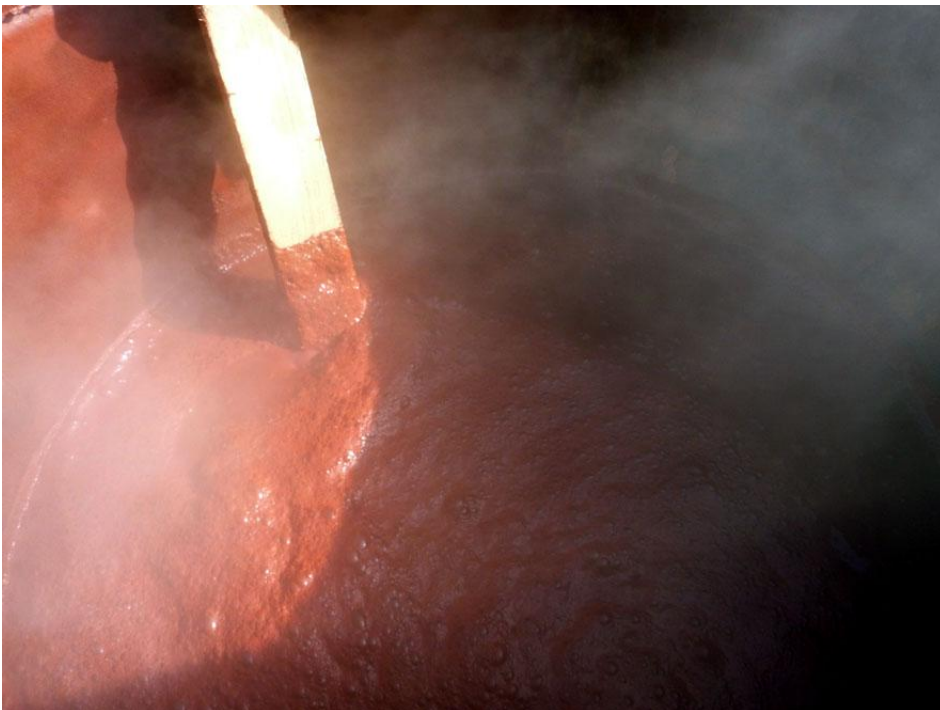
Malingen skal testes med en prøvepinne
